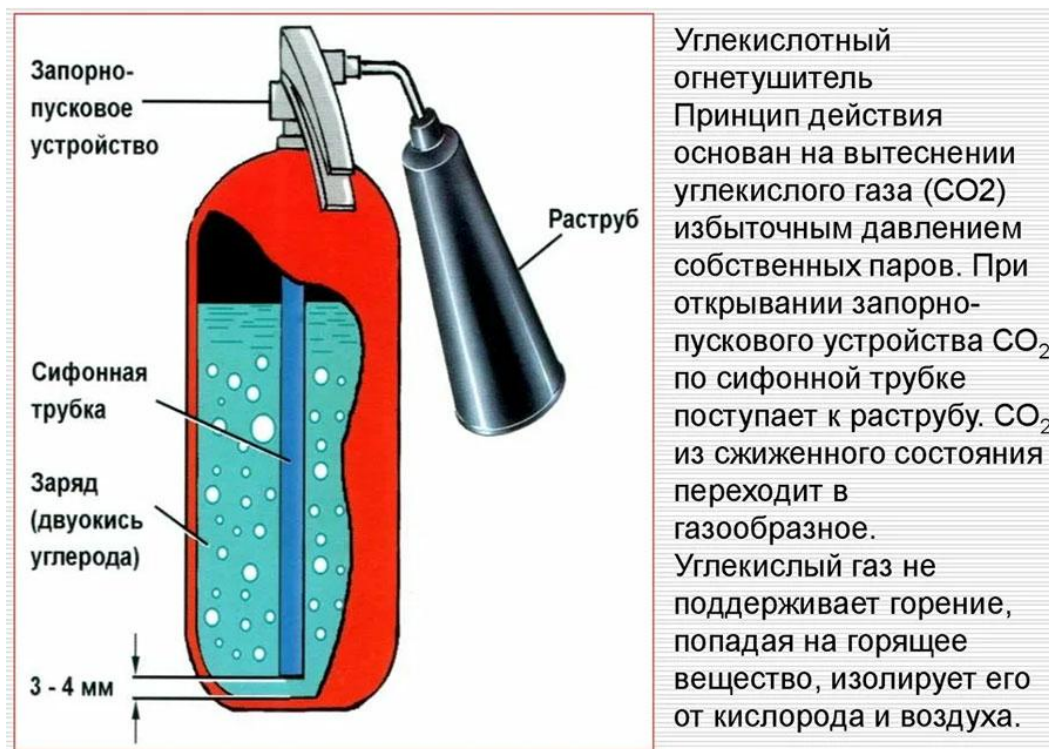
Устройство углекислотного огнетушителя
